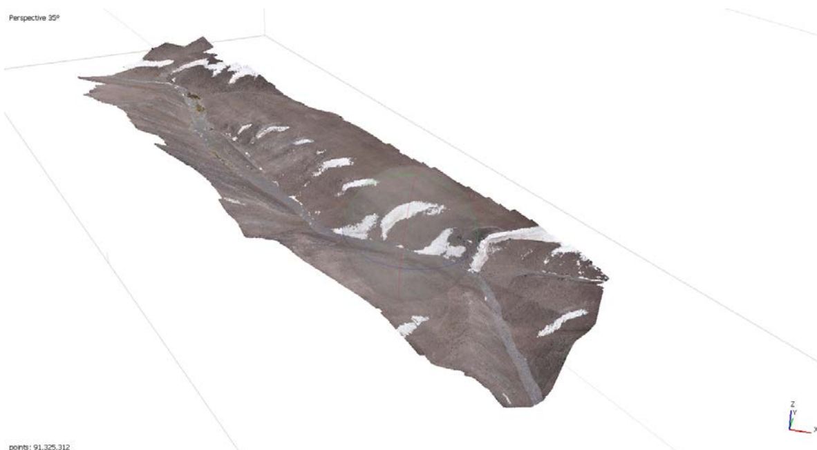
Figura 8-6, Ejemplo de nube de puntos de alta densidad obtenida sector Río negro
