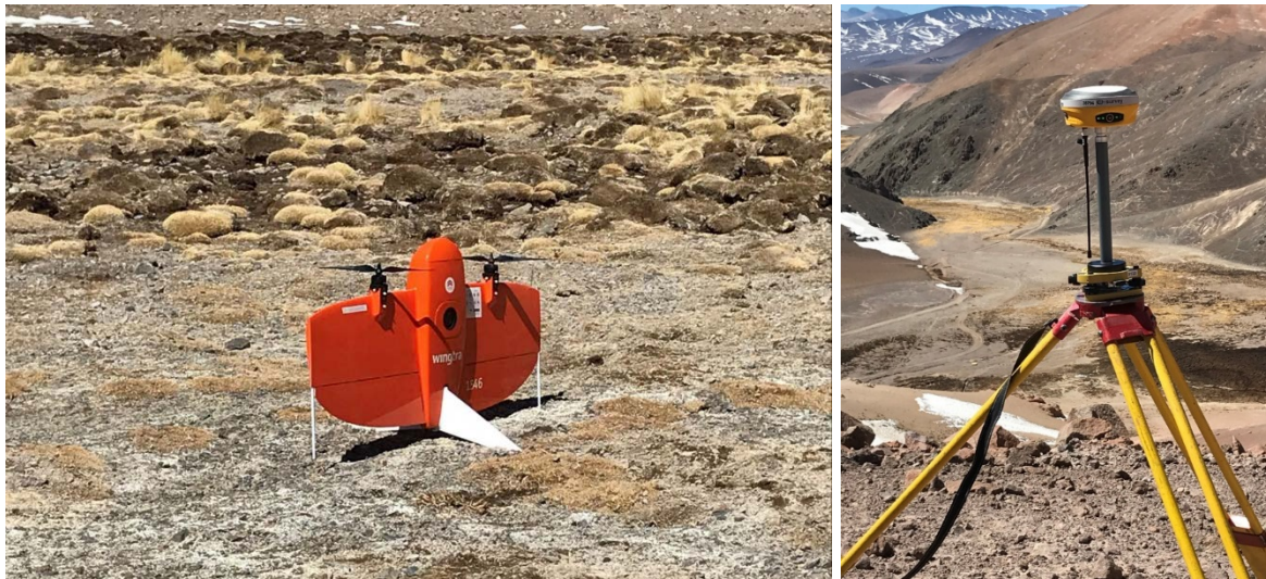
Figura 4-2 RPAS Wingtra One en posición de vuelo, y estación base,
