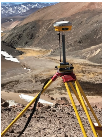
Figura 8-3 Estación base, sector Pastos Largos
