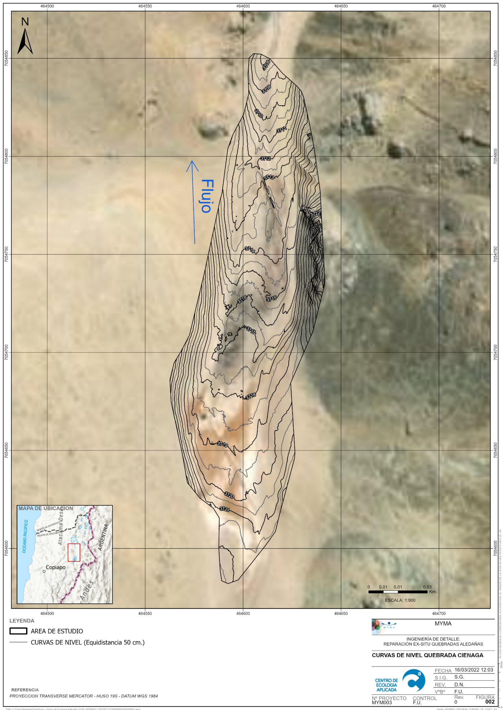
Figura 5-2. Curvas de nivel quebrada Ciénaga.
